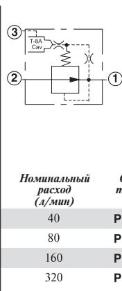
Для обеспечения 8-функционального управления в резьбовое гнездо Т-8А на торце клапана должна быть встроена пилотная ступень. Пилотные клапаны поставляются за отдельную плату и включают электропропорциональное, соленоидное, пневматическое и гидравлическое управление. О пилотных клапанах см. с. 121.
